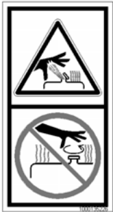
Fig.: 33: El depósito está bajo presión
