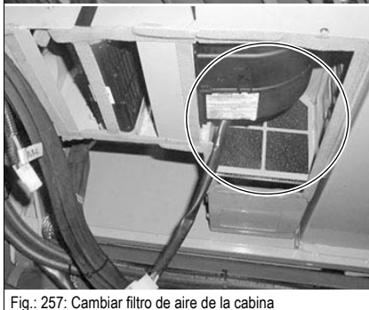
Fig.: 257: Cambiar filtro de aire de la cabina
