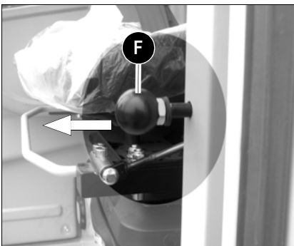
Fig.: 136: Aflojar el fijador de la puerta
