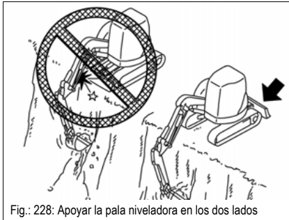
Fig.: 228: Apoyar la pala niveladora en los dos lados
