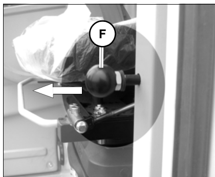
Fig. 118: Aflojar el fijador de la puerta
